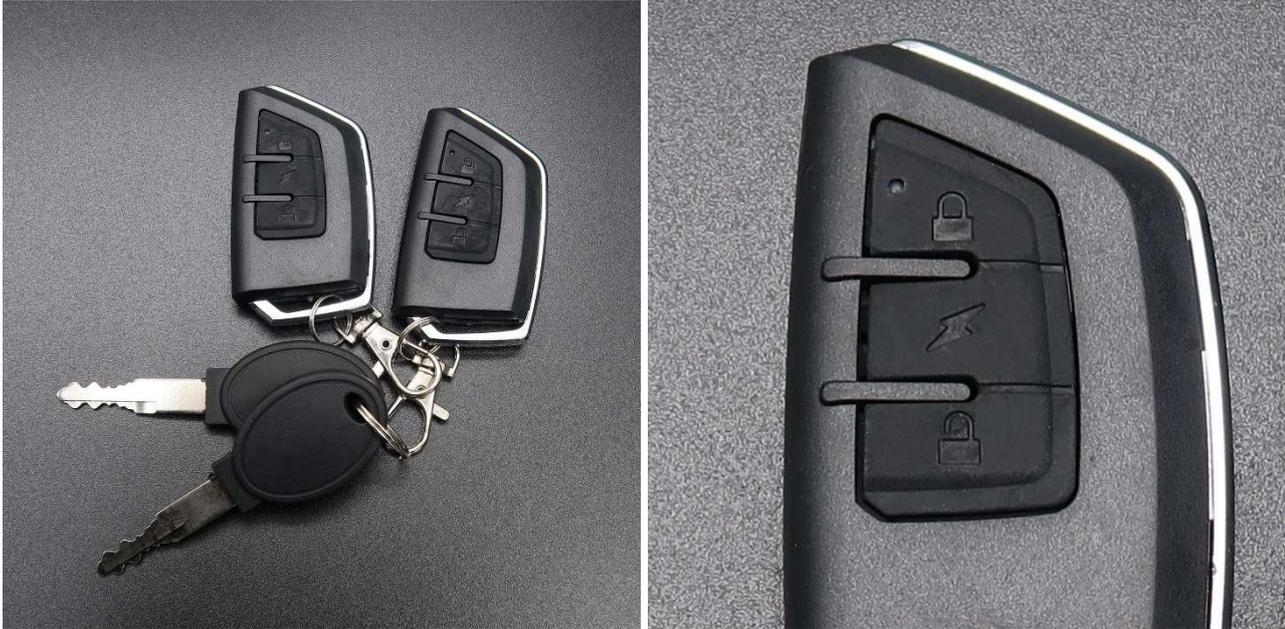
Mit der oberen Taste
