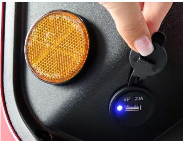
Die USB-Ladebuchse befindet sich an der vorderen Konsole, unter dem orangenen Reflektor und ist kompatibel mit jedem gängigen USB-Kabel.
