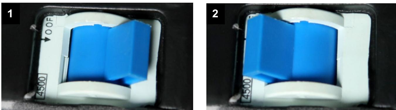
1. **Die Hauptsicherung ist ausgeschaltet:** Der Schalter befindet sich in Fahrtrichtung rechts und signalisiert, dass kein Strom fließt – es ist sicher.
