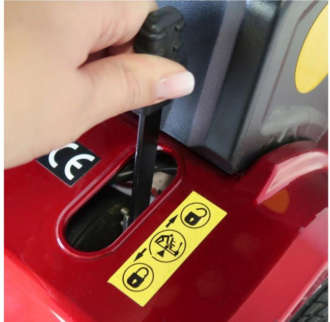
Wenn der Hebel nach oben zeigt (Schloss geöffnet), kann das Fahrzeug geschoben werden.
