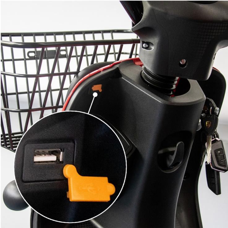
Die USB-Ladebuchse befindet sich an der vorderen Konsole links unterhalb einer orangenen, spritzwassergeschützten Kappe.
