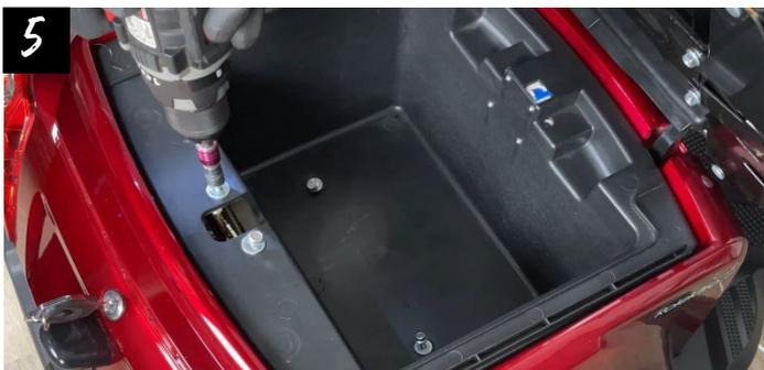
5 Als erstes lösen sie zwei Schrauben unten am Boden der Wanne und zwei Schrauben an der oberen Kante mit dem Sechskant-Steckschlüssel.
