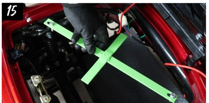
15 Lösen Sie die zwei Schrauben und nehmen Sie das Metallkreuz ab.
