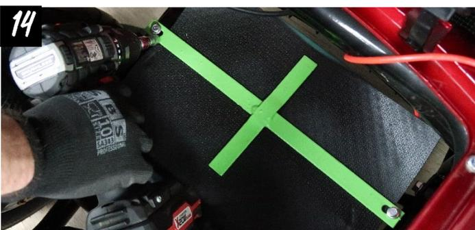
14 Die Akkus befinden sich unter einem Gummiteppich. Dieser ist mit einem Metallkreuz an den Rahmen befestigt.
