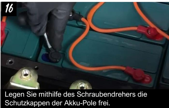
Legen Sie mithilfe des Schraubendrehers die Schutzkappen der Akku-Pole frei.
