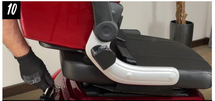
Drehen Sie den Schlüssel im Uhrzeigersinn, um den Sitz zu entriegeln, gleichzeitig heben Sie den Sitz etwas hoch.
