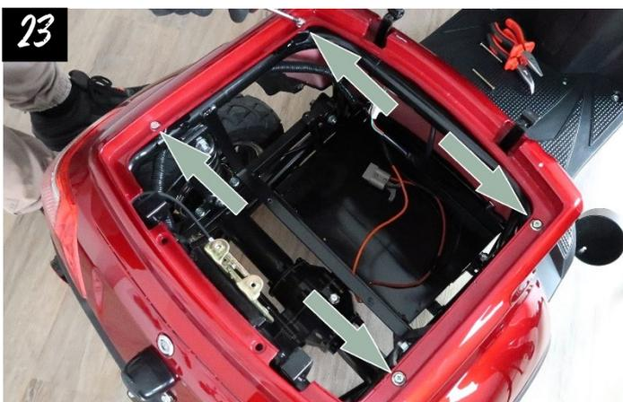
Jetzt lösen Sie vier Schrauben an der hinteren Verkleidung oben.
