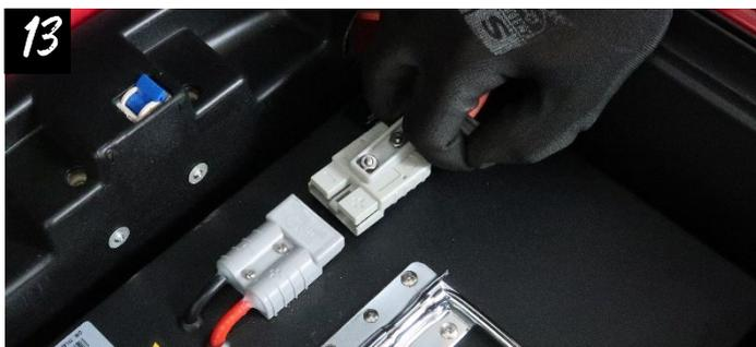
Bei V.3 Modellen mit Lithium-Akku muss zuerst der Akku herausgenommen werden. Ziehen Sie dazu den Stecker vom Akku ab.
