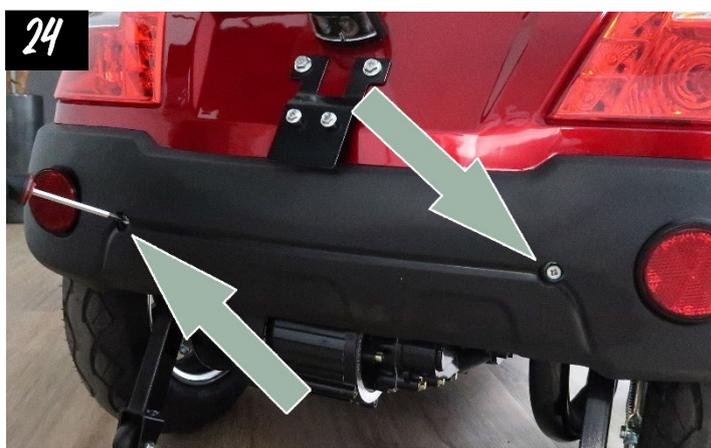
Als weiteres lösen Sie zwei Schrauben an der hinteren Verkleidung hinten.
