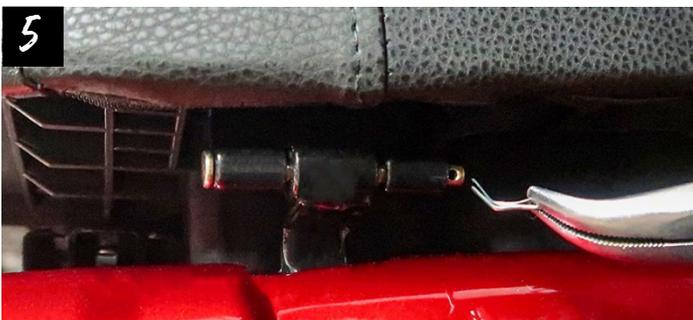
5 In der Sitzhalterung befindet sich ein Metallstift, der mit einer Sicherheitsnadel befestigt ist. Die Sicherheitsnadel muss herausgezogen werden.
