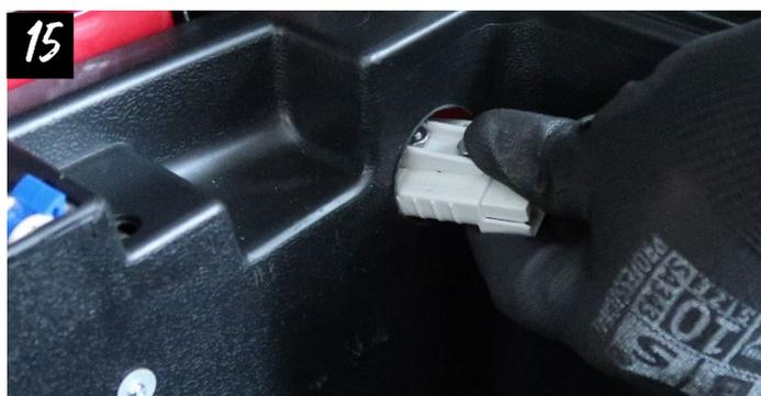
Drücken Sie den Batteriestecker des Fahrzeugs durch die Öffnung der Batteriewanne.
