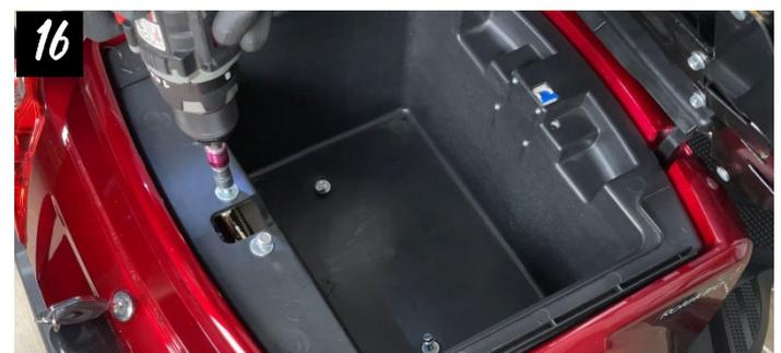
Als nächstes lösen sie zwei Schrauben unten am Boden der Wanne und zwei Schrauben an der oberen Kante mit dem Sechskant-Steckschlüssel.
