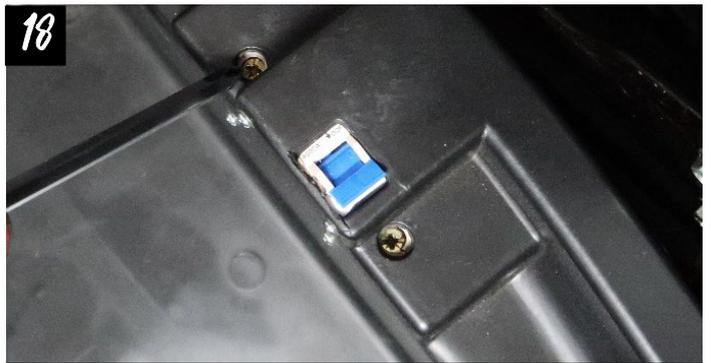
Um die Verkabelung zu trennen, muss man zwei Schrauben oben lösen.
