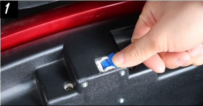
1 Die Hauptsicherung bitte auf OFF stellen. Diese befindet sich unter dem Sitz.
